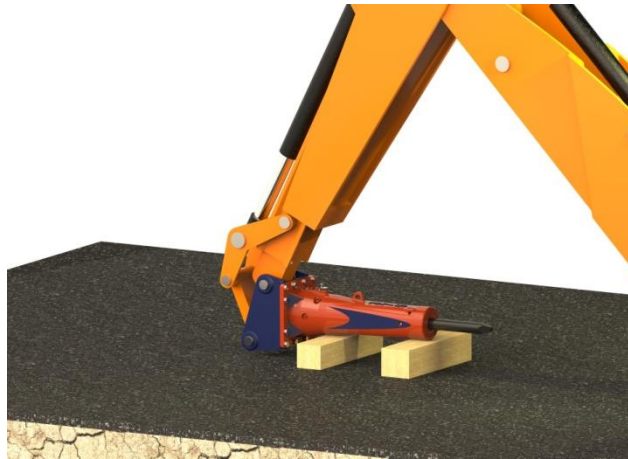
Ilustración 14: Colocación sobre terreno firme y nivelado.
