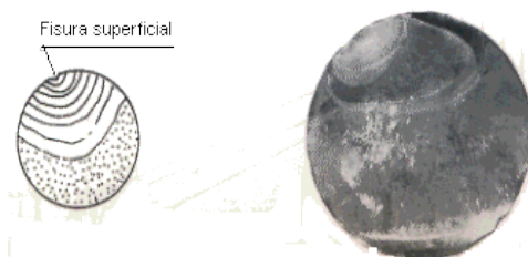
Ilustración 30 : Rotura por fatiga
