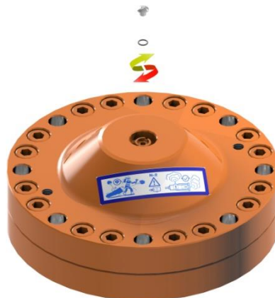
Ilustración 42: Retirar tapón y junta tórica.
