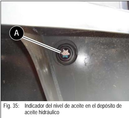
Fig. 35: Indicador del nivel de aceite en el depósito de aceite hidráulico
