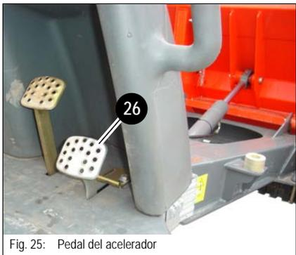
Fig. 25: Pedal del acelerador
