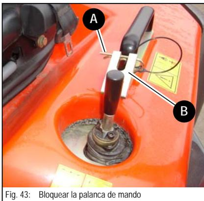
Fig. 43: Bloquear la palanca de mando
