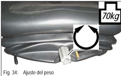
Fig. 34: Ajuste del peso
