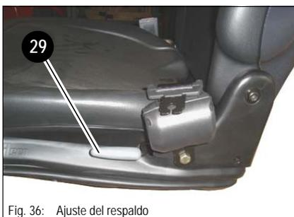
Fig. 36: Ajuste del respaldo
