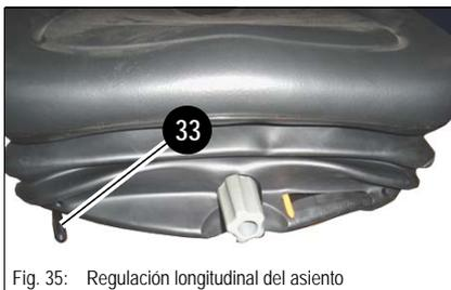
Fig. 35: Regulación longitudinal del asiento
